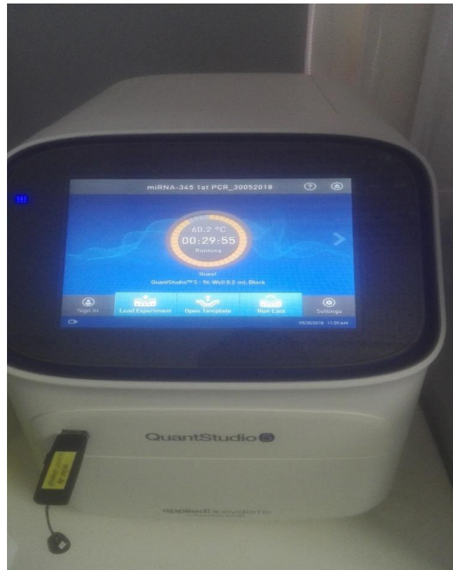
Slika 15. QuantStudio 5 real-time PCR uređaj.
