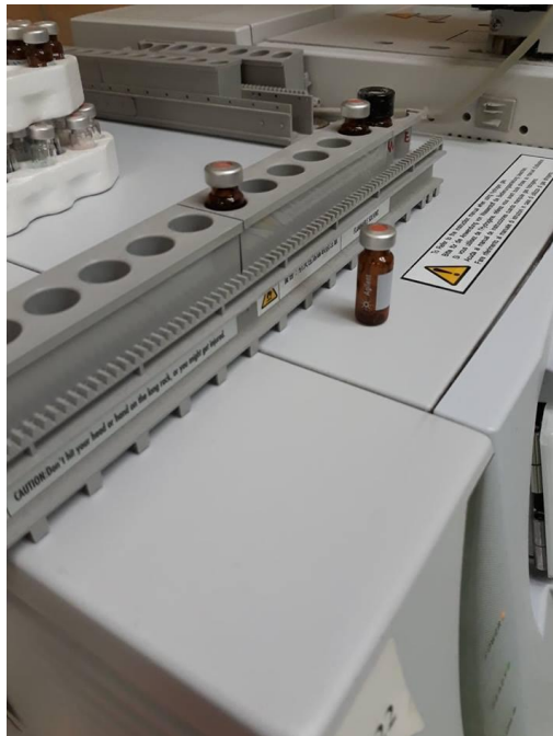
Slika 9: Postavljanje uzorka na GC-MS (fotografija autorice)
