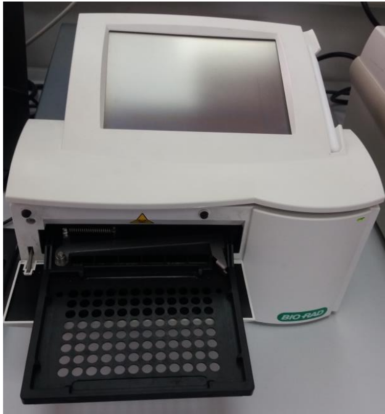
Slika 8. Spektrofotometrijski mjerač apsorbance s ladicom za test-pločicu (fotografirala autorica)
